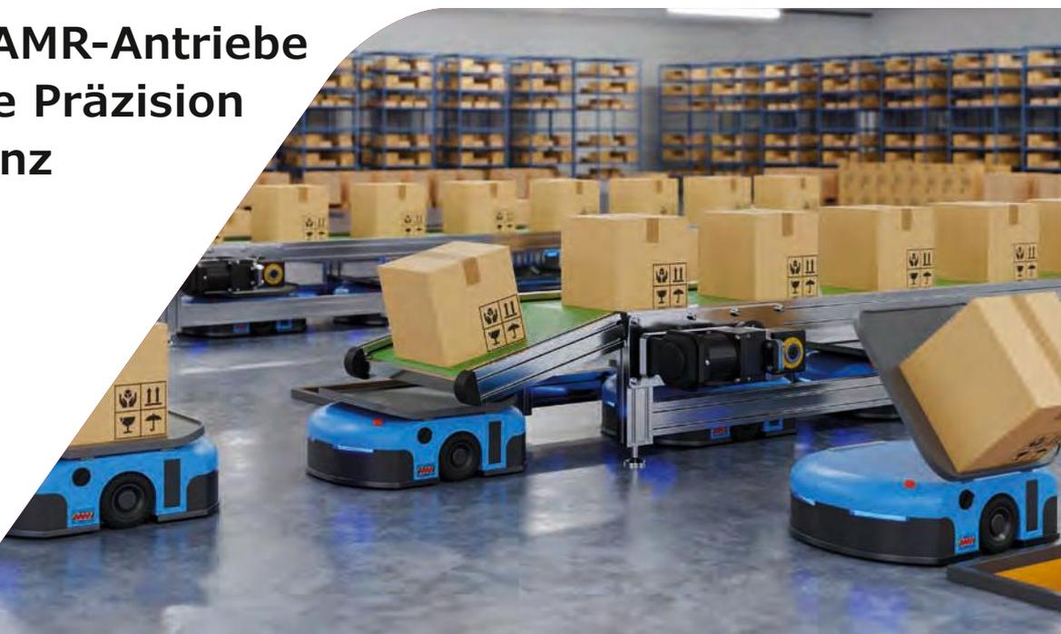
MOTORIZED ROLLERS für Lastaufnahme-mittel zur einfach/mehrfachtiefen Lagerung von Kartons, Behältern oder Kleinladungsträgern (KLT).
